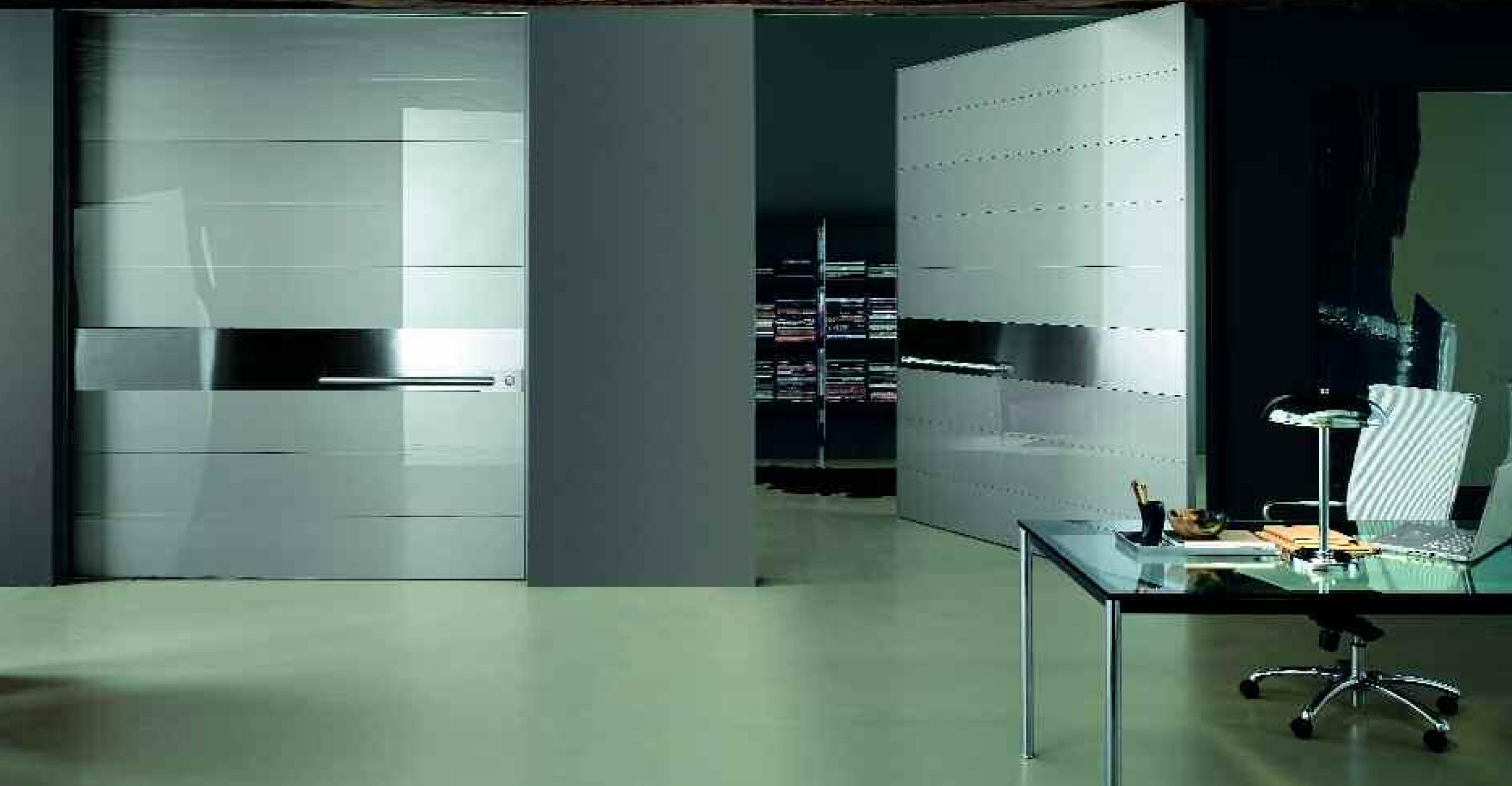
L'apertura dell'anta é a "bilico verticale", per mezzo di due perni (uno inferiore e uno superiore) completamente regolabili, a totale scomparsa, che fungono da fulcro. In questo modo l'anta ruota su sé stessa consentendo un comodo passaggio e un'ampia luce.
