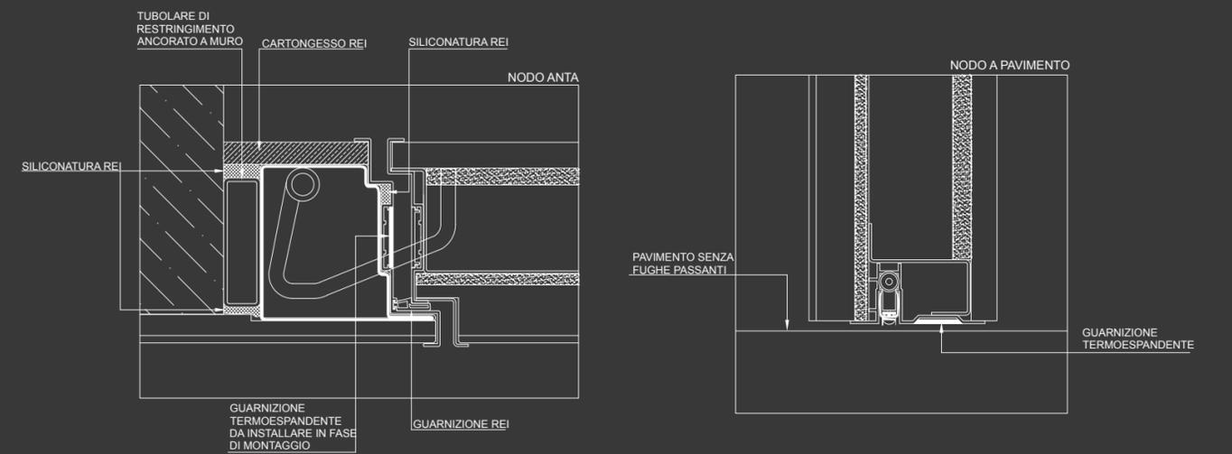
\_ dettagli tecnici e d'installazione
