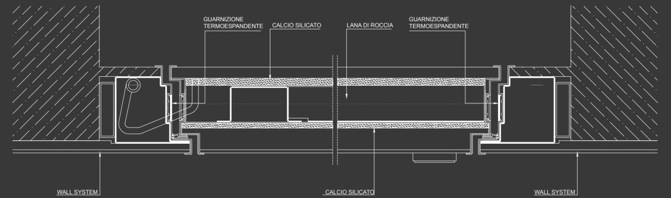
\_ sezione orizzontale Tekno El rasomuro esterno con Synua Wall System
