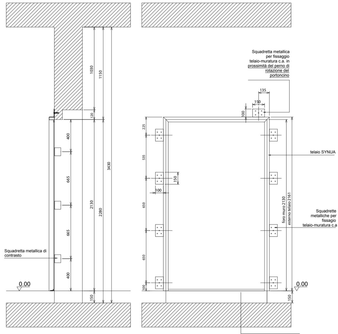
\_ eseguiti per installazione in cantiere ancoraggio telaio
